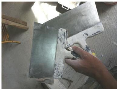
Couteaux permettant l'application et le lissage de l'enduit intérieur entre les plaques de BA13.
