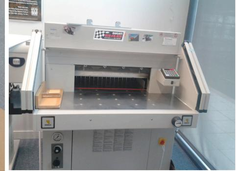
Il y aurait pu avoir un risque lié à la manutention mécanique avec le massico une sécurité infrarouge est placé autour de la zone de coupe et la machine s'arrête automatiquement dès que l'opérateur pénètre dans cette zone.
