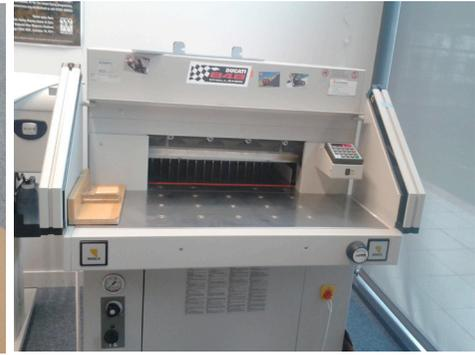
Il y aurait pu avoir un risque lié à la manutention mécanique avec le massico une sécurité infrarouge est placée autour de la zone de coupe et la machine s'arrête automatiquement dès que l'opérateur pénètre dans cette zone.
