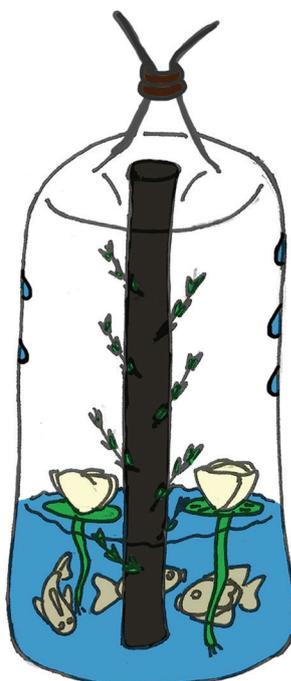
Une gaine en plastique transparent permet de cultiver à la fois plantes et poissons comestibles. On crée ici un circuit fermé, avec l'eau qui s'évapore, nourrit les plantes et retombe par condensation.
